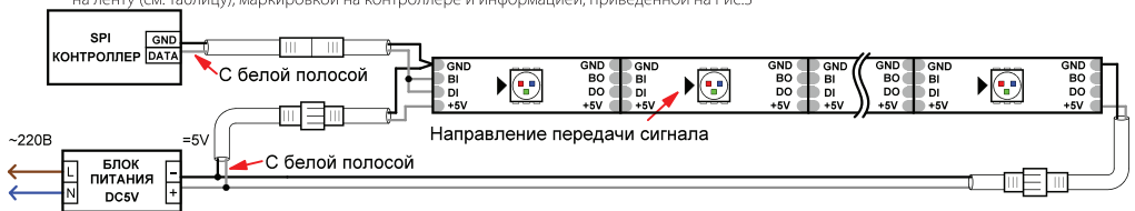
Рис.1. Схема подключения одной светодиодной ленты «Бегущий огонь».
