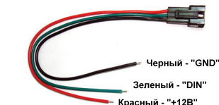
Рис.3. Кабель для подключения открытой ленты и ленты с индексом «SE»
