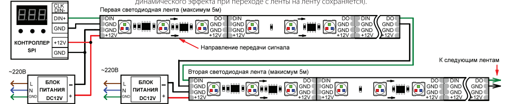
Рис.2. Схема подключения ленты при управлении от внешнего контроллера.
