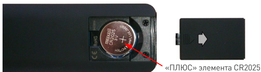
Рис. 1. Установка элемента питания.
