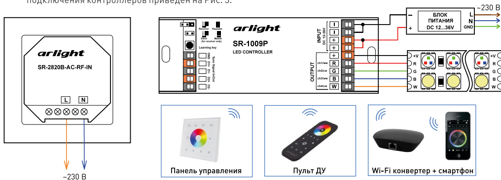
Рис. 3. Схема подключения оборудования на примере контроллера SR-1009P.
