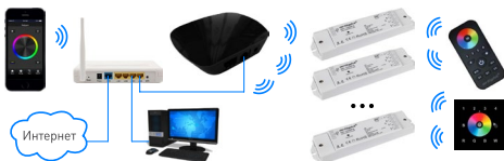
Рис. 3. Подключение через роутер с использованием проводного соединения.
