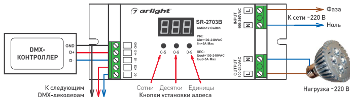
Рис. 1. Схема подключения декодера, органы управления и индикации.
