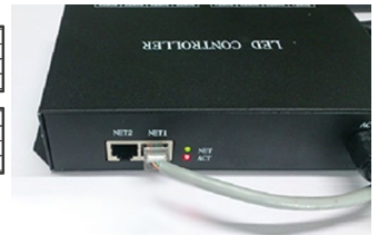
Рис. 2. Подключение контроллера HX-801RC к мастер-контроллеру или компьютеру.
