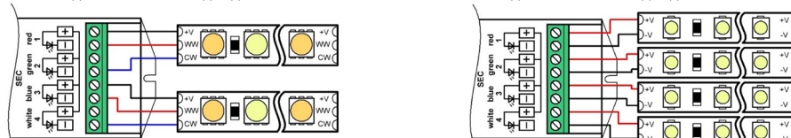
Рис. 4. Подключение светодиодной ленты MIX (WW – теплый белый, CW – холодный белый).
