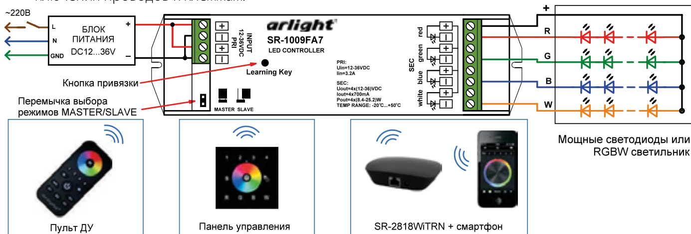
Рис. 1. Схема подключения и варианты управления контроллером.
