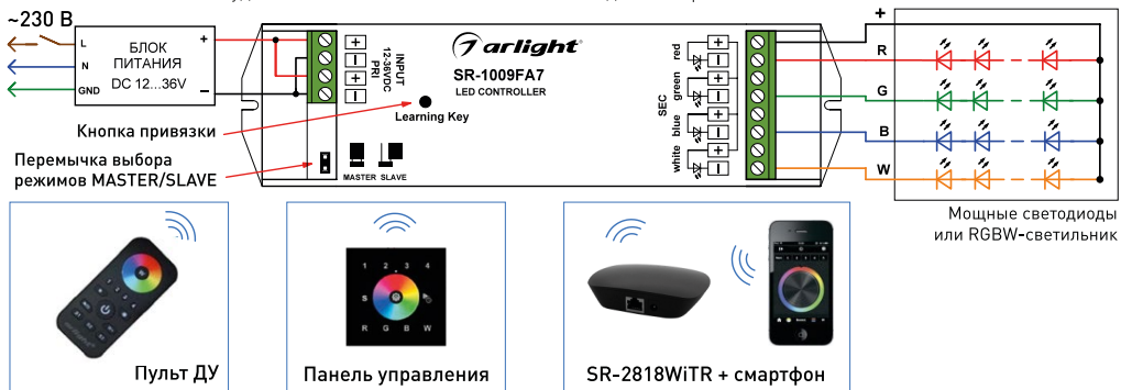
Рис. 1. Схема подключения и варианты управления контроллером.
